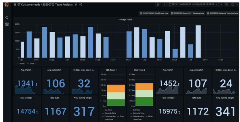
**Bild 11:** Analyse der Abbaumenge verschiedener Gruppen von Continuous-Miner-Bedienern
