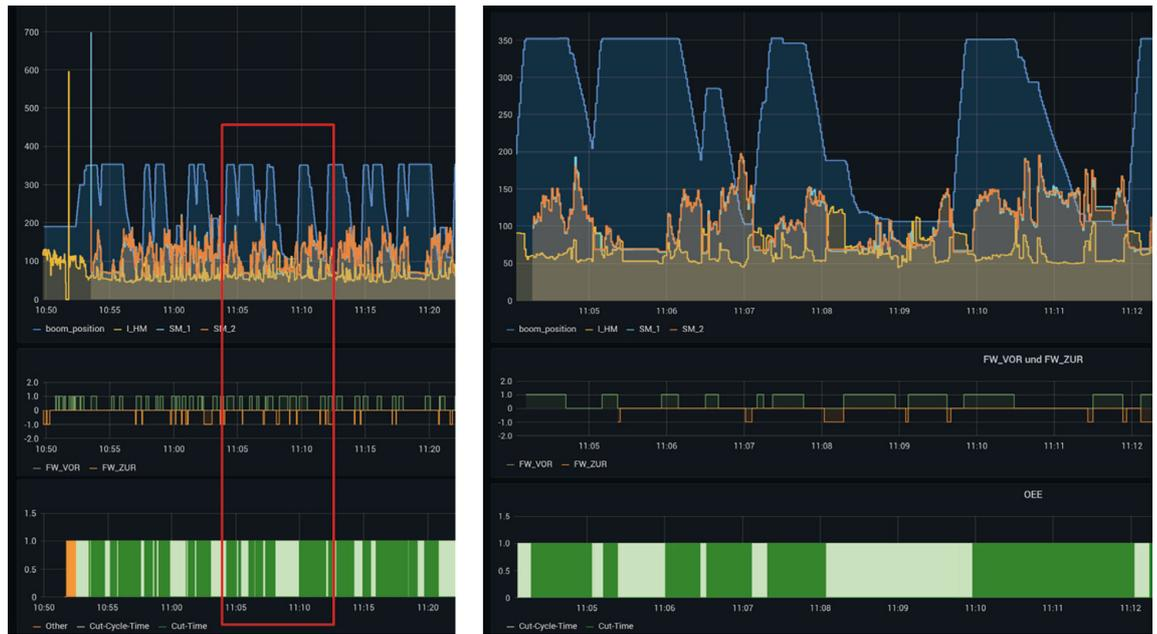
**Bild 5:** Gewinnungszyklen eines Continuous Miner in zwei temporalen Zoom-Stufen
